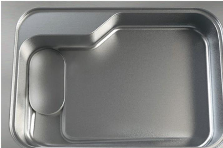
採用されなかったシンクの形状。排水口までの溝の幅が広かったため、水の勢いがなくなり生ゴミが停滞。洗い物を置く場所も限られる
