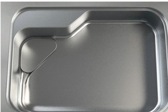
採用されたシンクの形状。溝の幅や深さ、コーナーの丸みなどを調整し、生ゴミが勢いよく流れるようにした。洗い物を置く場所を確保しつつ、排水カゴの容量を確保するため、排水口を三角形に変更
